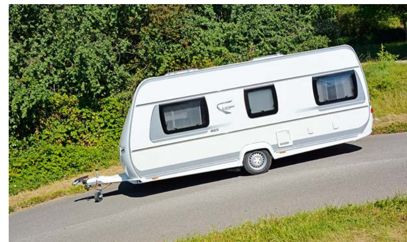
Op een heuvel met een stijging tot 10 procent doen beide systemen het prima, maar met steilere hellingen wordt het wat moeilijker. Steeds weer vallen eerst de Mover Smart en daarna de Easydriver voor korte tijd uit. Na een korte onderbreking gaan ze echter verder en rijden ze allebei de heuvel op.
