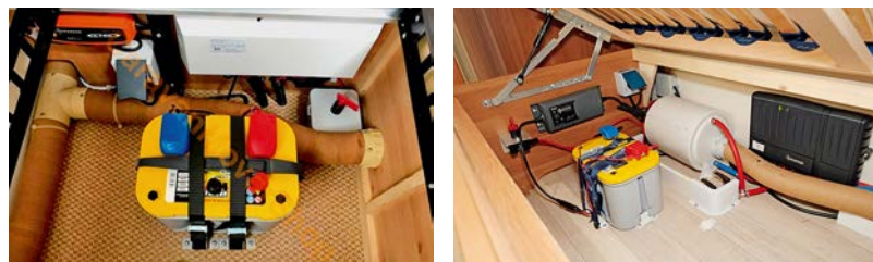
De Mover Smart A heeft ook een compacte afstandsbediening. De centrale schakelaar bevindt zich naast de accu.
