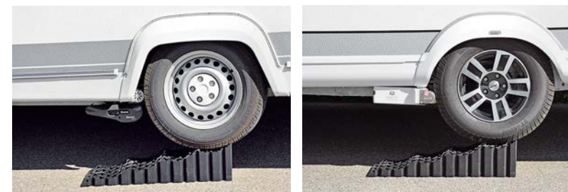
Het 'beklimmen' van een oprijblok lukt goed met beide systemen, maar je moet snel wisselende besturingscommando's geven, omdat het rechtuitrijden niet volautomatisch gaat zoals met duurdere systemen.
