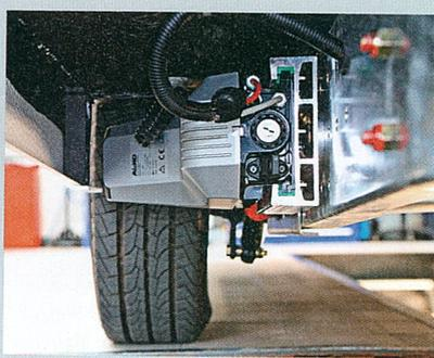
*Zwei Systeme, zwei Anbauarten: während das Mammut (rechts) direkt ans Chassis geschraubt werden kann, muss der Mover XT (links) geklemmt werden. Beide können vor und hinter der Achse montiert werden.*
