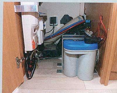
*Zwei Systeme, zwei Batterien: Truma (links) spart Gewicht, da wegen des geringen Stromverbrauchs eine Kompaktbatterie genügt. Al-Ko setzt auf Größe, da sie auch zur Bordversorgung dienen kann.*
